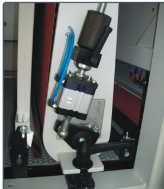
Pneumatic control height of the roller Pneumatische Zuspung und Absprung der Kontaktwalze Pneumatické zvedání brousících válců Pneumatyczne sterowanie wysokości wałów Пневматическое управление высоты шлиф. валов
