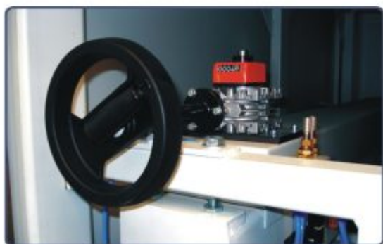
Manual adjustment of brushes - Manual steuern für Bürste - Výškové nastavení kartáčů - Sterowanie szcotok - Управление щеток
